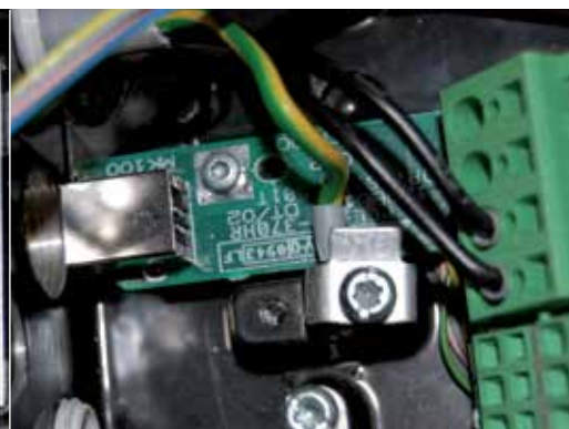
Bornes aisément accessibles pour la boucle interne
